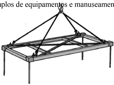
Exemplo de elevação de contentores utilizando um feixe de elevação equipado com ganchos, manilhas ou bloqueio acoplada manualmente
